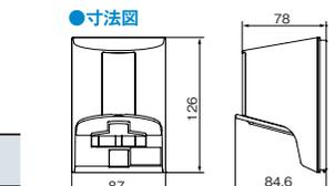
●防水保護等級: JIS C 0920 [IP44] 相当 (コンセントカバーが閉まっている状態、電源プラグが接続状態)。
