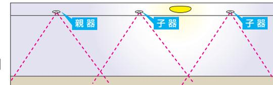
親器(WTK2411K、WTK24111K)に子器(WTK2911K、WTK29111K)が2台まで接続でき、最大3箇所まで検知が可能です。親器と子器のどちらに人が来ても照明器具が点灯します。
