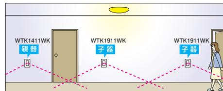
親器(WTK1411WK)1台に子器(WTK1911WK)が2台まで接続でき、最大3箇所まで検知が可能。親器と子器のどちらに人が来てても照明器具が点灯します。
