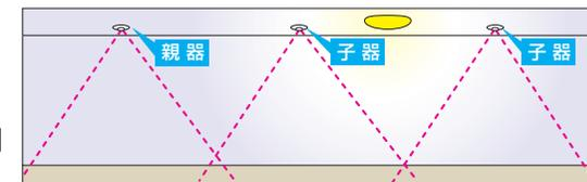
親器(WTK2411K、WTK24111K)に子器(WTK2911K、WTK29111K)が2台まで接続でき、最大3箇所まで検知が可能です。親器と子器のどちらに人が来てても照明器具が点灯します。
