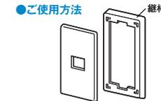
継棒にプレートを乗せて取り付ける。
