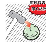
2 コンクリート打設後、釘をベンチで斜めに引抜きます。
