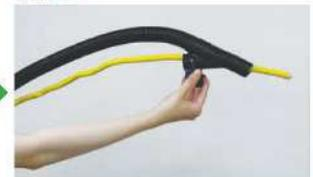
コルゲートチューブのスリットがある側を内側にし、治具に差し込む
