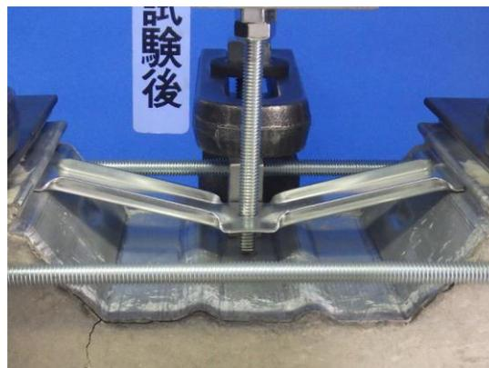
試験機の制約上、十分な厚み・サイズのコンクリート試験体での試験が実施できなかった。5kN程度でコンクリートにひびが入った。離反荷重までは、鋼製治具と同様のグラフ形状となった。
