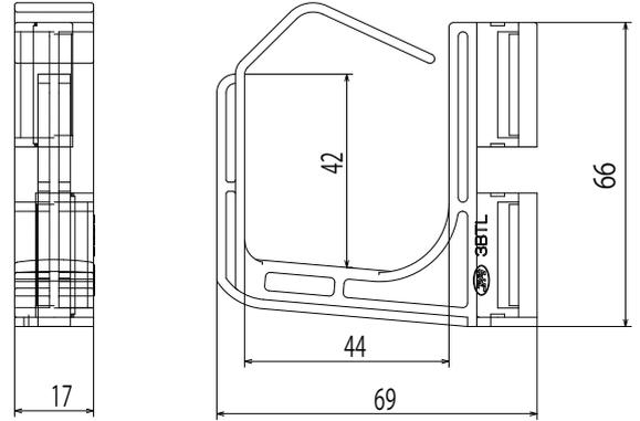
■適合管サイズ：CD管・PF管・さや管φ42以下
